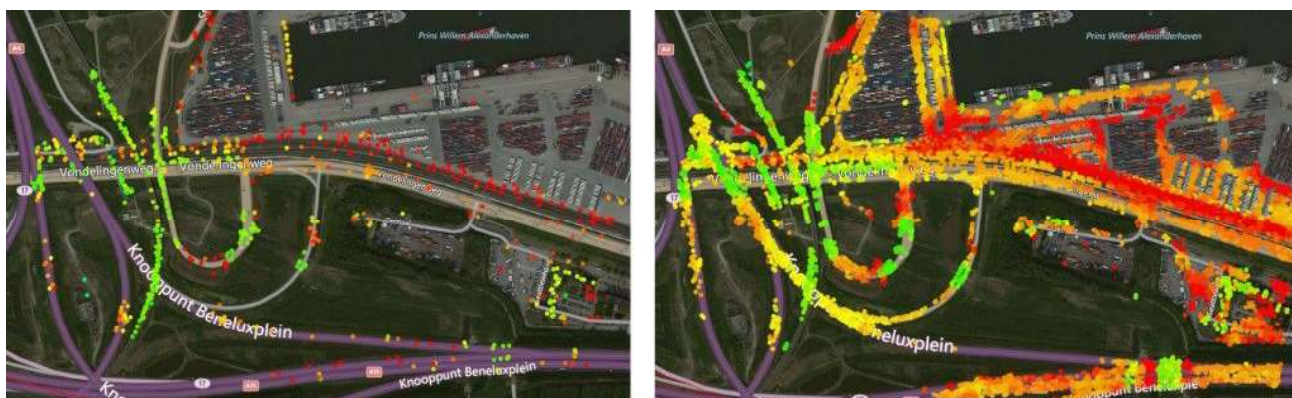
Obrázek 30: Ukázka satelitních dat s nízkým standardním rozlišením (6-8 mm, levý obrázek) a vysokým rozlišením (2-3 mm, pravý obrázek) při individuálním měření, kontinuální měření dosahuje přesnosti menší než 1 mm.
