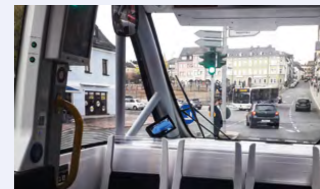
Autonomní minibus se rádiem „domluví“ se semaforem a na zelenou vyrazí do křižovatky
